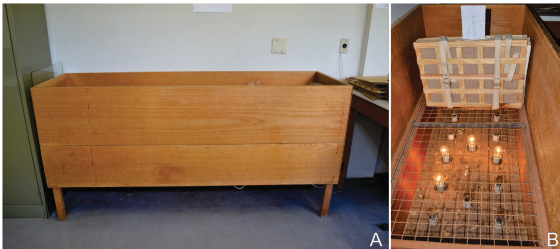
Figura 5: Estufa para secagem de material botânico. A: Visão lateral de uma estufa de madeira. B: Visão interna da estufa com prensa apoiada sobre a grade, que está acima das lâmpadas (fonte de calor), para a secagem de plantas.
