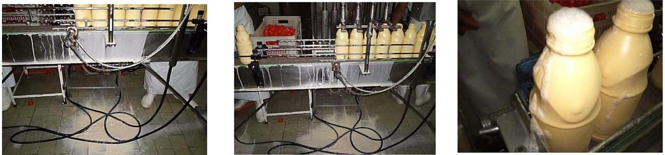
Figura 4 – Exemplo de geração de efluentes em vazamentos e derramamentos provenientes de falhas nos processos
